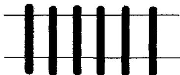
いて厚めのバルサを羽の形に何枚か切りだしていく。その際、予め容易したヒノキ棒のサイズの穴をバルサの下方に前後左右 2 つ開けておく。そして、それをヒノキ棒（細めで可。図 2 の細線）の上に決めた個数だけ先に用意したバルサを差し込んでいく（図 2 の太線）。最後にバルサとヒノキの結合部を接着し、できたものの表裏に薄めのバルサシートを貼って、それをテープ（今回使用したのは透明な梱包用テープ）で覆ってコーティングする。今回は逆ガル翼なのでこれを 4 個作って、2 つを角度をつけてテープで止めて 1 つの翼とした。
