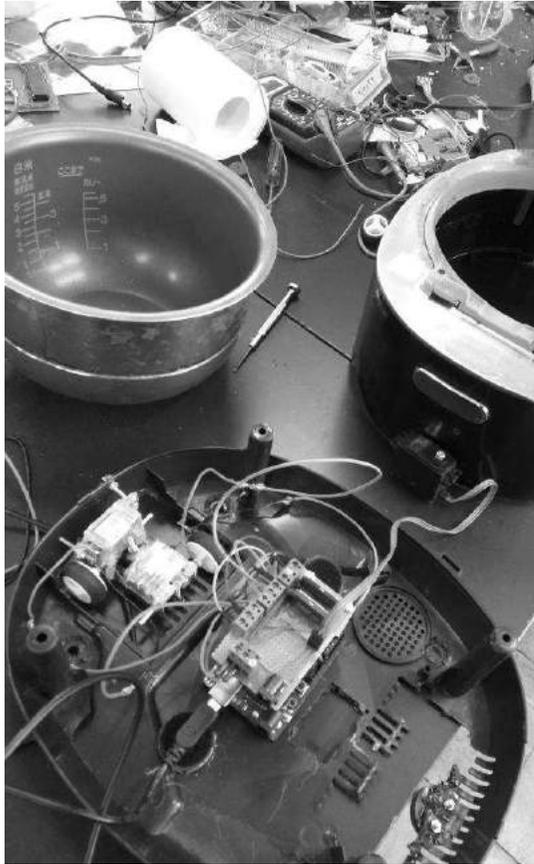
左の写真のように、炊飯釜を取り外し、炊飯器の底辺に制御基板(マイコンボードのarduino UNOとarduino用bluetoothモジュール、モータ配線用の基盤)を三段重ねにして置いています。
